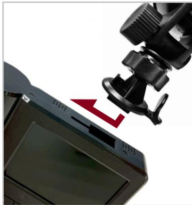
2. Antes de la instalación, asegúrate de limpiar el área del parabrisas seleccionada. Para una visibilidad óptima, considera montar la cámara de tablero en el centro del parabrisas, aproximadamente a la altura del espejo retrovisor.
